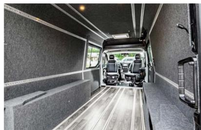
**Airlineschienensystem am Boden, Dach und an Seitenwänden**
