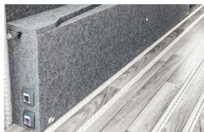
**Radkastenverkleidung links, Staufach für Elektro-Paket**
