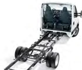
**35C:** châssis-cabine allégé à pneus jumeaux
